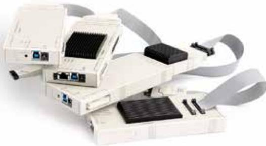
PowerDebug はモジュラ式のパワフルで柔軟なデバッグシステムで、組込み業界で最も幅広いチップとコアアーキテクチャをサポートしています。
